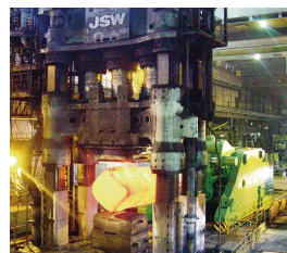
14,000トン水圧プレス 14,000-ton Water Hydraulic Forging Press
