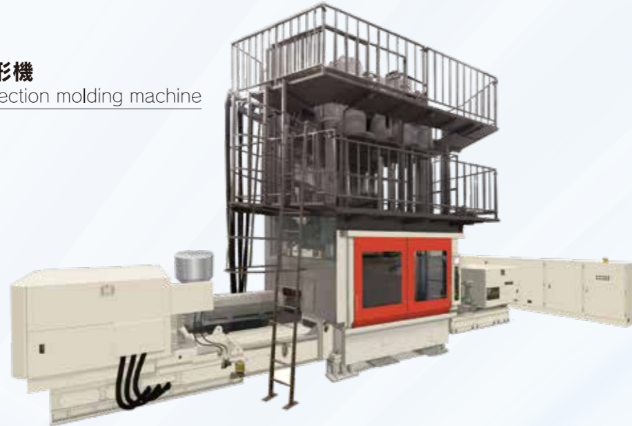
縦型ロータリー多色射出成形機 Vertical rotary multicolor injection molding machine
