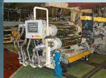
フィルム・シート製造装置
