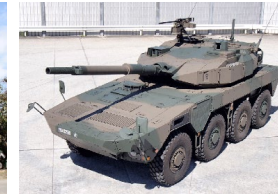
105mm施線砲 (16式機動戦闘車用) (写真：陸上自衛隊HPより引用)
