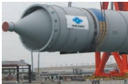
当社製クラッド鋼板を使用したコークドラム (写真:住友重機械工業株式会社殿 ご提供)
