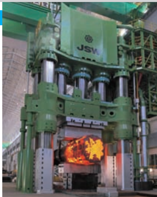
室蘭製作所で稼動を開始した新14,000トンプレス機
