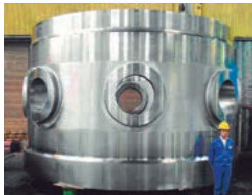
原子炉圧力容器用シェルフランジ
