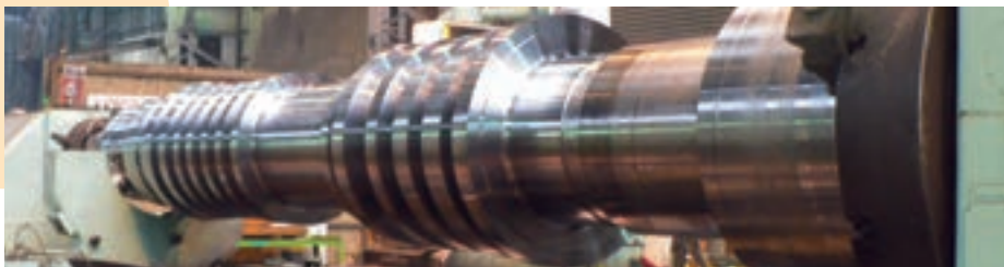
高強度・高耐熱材を用いたロータシャフト
