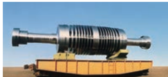
発電用ロータシャフト
