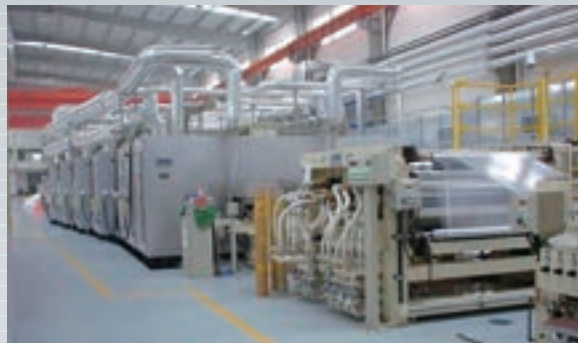
フィルム・シート製造装置
